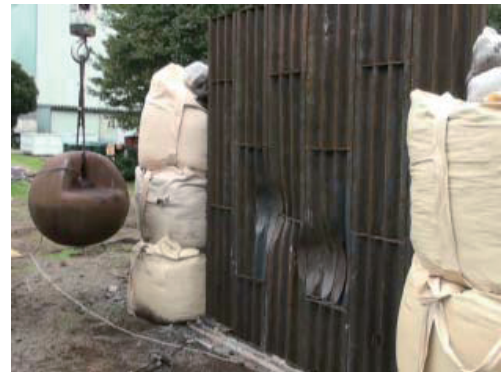
写真3 外部保護材の変形状況
